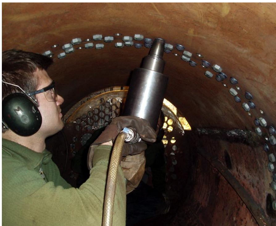
Användning av pneumatiskt mothåll.
