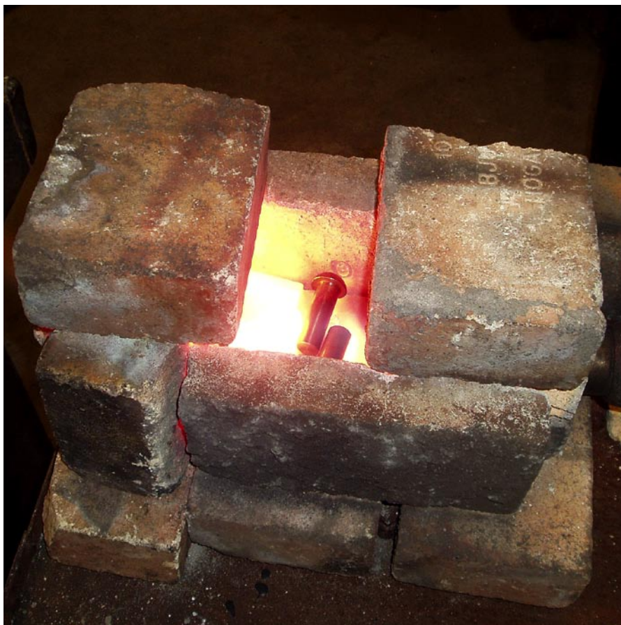
Värmning av nit i enkel gasolugn.
